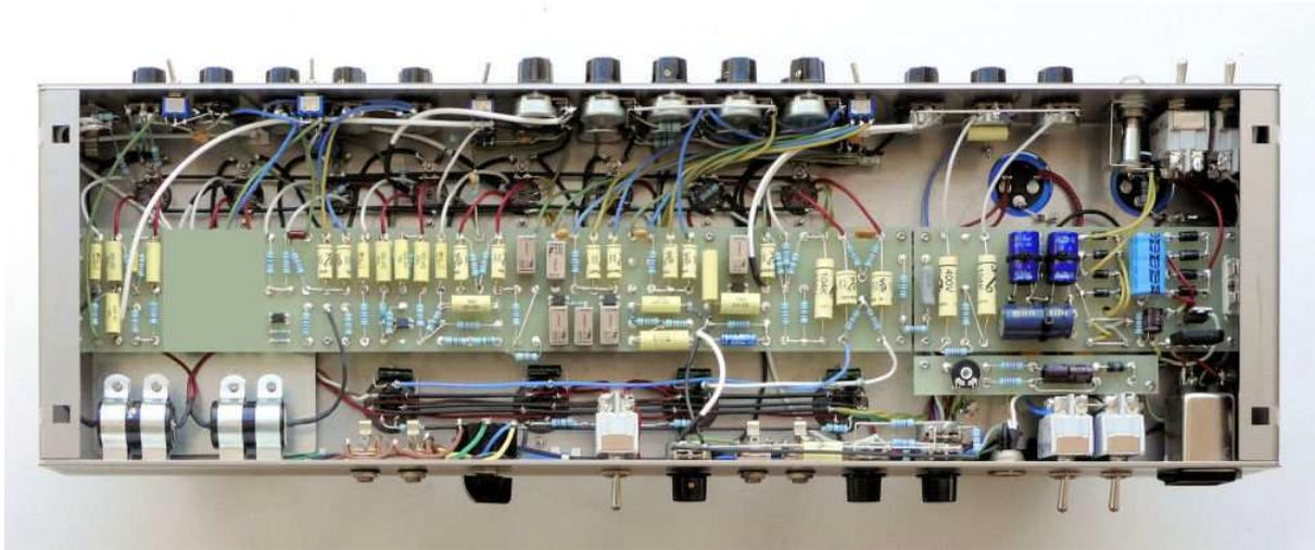
Beim direkten Verlegen von Bauelementen wie Widerstände sollten je nach Einbaulage die Beinchen isoliert werden. Am ersten Poti links im Bild sieht man das sehr schön. Hierfür eignet sich entweder Gewebband oder durchsichtiger Silikonschlauch. Dieser ist jedoch relativ empfindlich und neigt schnell zur Rissbildung. Ganz neue habe ich jetzt einen durchsichtigen Schrumpfschlauch gefunden. Isoliert perfekt und sieht auch noch gut aus.
