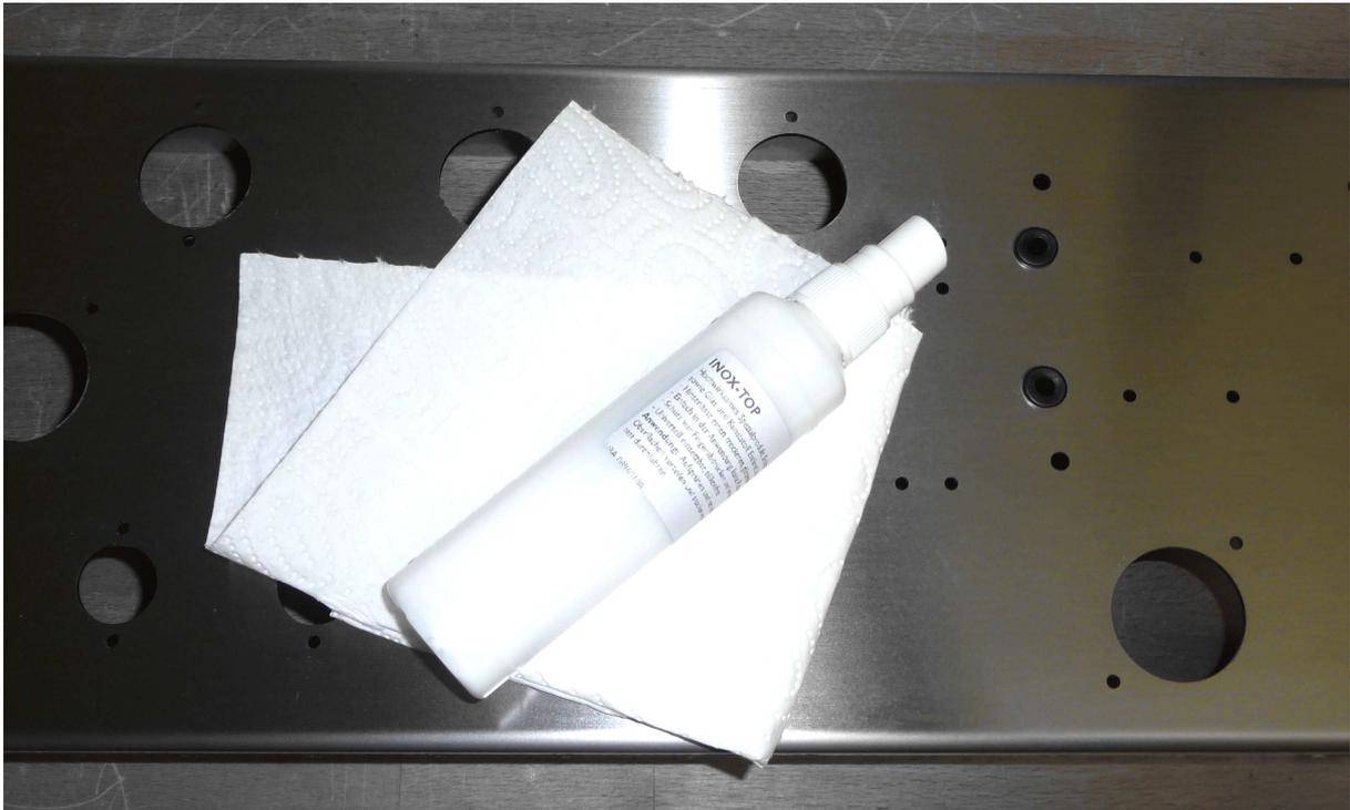
Damit die dicken APEM-Schalter einen besseren Halt haben und sich nicht so leicht verdrehen habe ich gleich die entsprechenden Nasen vorgesehen. Anders als bei anderen Schaltern (z.B. die kleinen Hebelschalter) oder Potis, die ein zweites Loch brauchen, das man mal schnell selber bohrt, ist das bei diesen Durchbrüchen selbst praktisch fast nicht mehr herstellbar. Ein Hoch auf den Laser, dem ist es egal wie ich die Schnitt-Linien im CAD zeichne.
